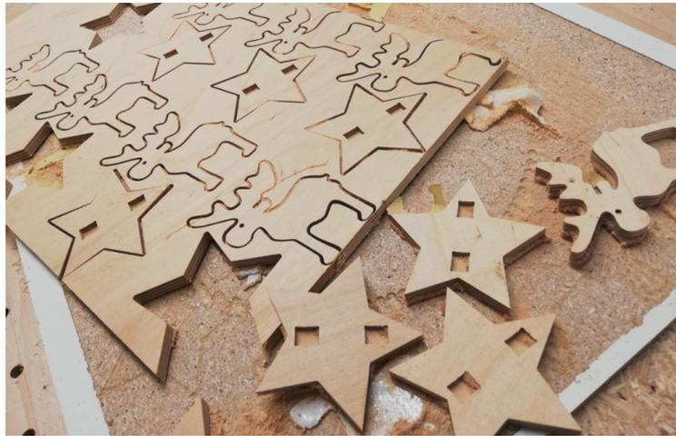
Oder an den Außenkanten/Ecken die Platte mit Spannpratzen oder Holzschrauben fixieren, dann werden aber Stege benötigt, damit die ausgeschnittenen Teile an ihrem Platz bleiben!
