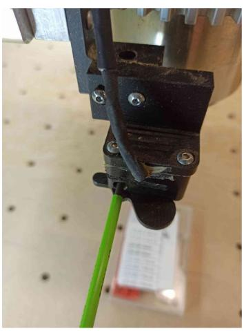
man, wie das Kamerabild "wandert". Deshalb ist das Klemmen der Linse so wichtig, sonst könnte sich später das Fadenkreuz verstellen. Zum Ausrichten der Achsen benötigen wir eine Referenz, parallel zu unseren Achsen. Dazu ein Kreuz in die Opferplatte auf den aktiven Nullpunkt gravieren. Wenn der Kontrast des Materials nicht ausreichend ist, kann die Gravur mit Bleistift nachgezogen und der Überstand dann abgeschliffen werden.
