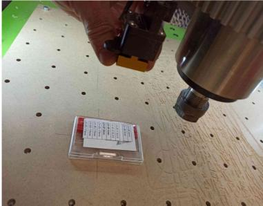
Zum Einstellen der Bildschärfe / Linse der Kamera, den Fokus auf das Werkstück richten. Dazu ein Stück bedrucktes Papier auf den Maschinentisch legen.
