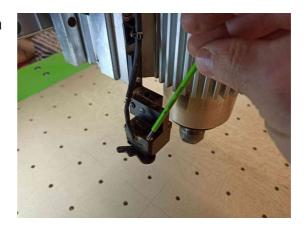
Über dem Kreuz wird als erstes die Drehung ausgerichtet. Dazu die vier Schrauben lösen. Mit der Maschine das Kreuz anfahren und die Kamera drehen, bis das Fadenkreuz mit der Gravur deckungsgleich ist.
