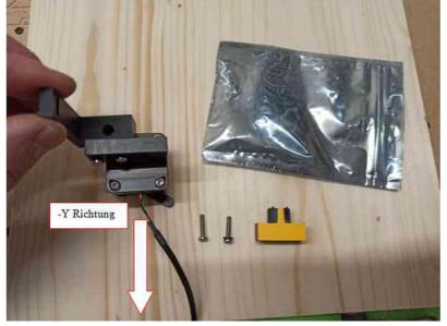
Die Kamera nur mit den mitgelieferten Linsenkopfschrauben oder geeigneten Linsenkopfschrauben befestigen. Bei Montage in Holz einfach mit D2.5mm bohren und die Gewindeschrauben direkt eindrehen. Ein Gewinde formt sich von selbst.
